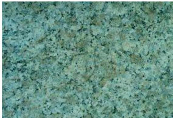
El área de Los Menucos centraliza la actividad de las canteras de Piedra Laja. Debido al lajeado característico que presentan, se destina a revestimiento mediante un proceso de aserrado, mientras que la destinada a pavimento se comercializa en bruto.
